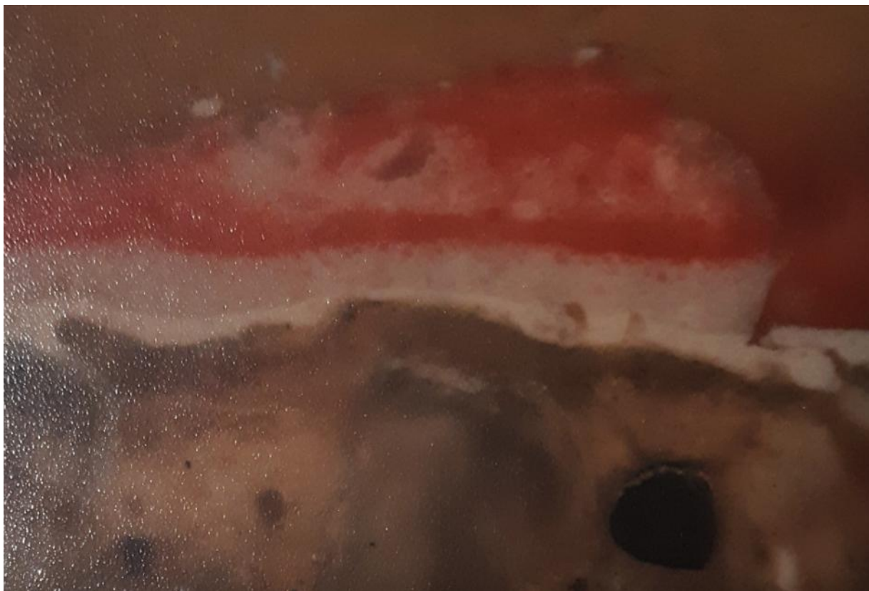
Erb Litomyšle - Mikronábrus původní červené vrstvy, zvětšeno 125x.
